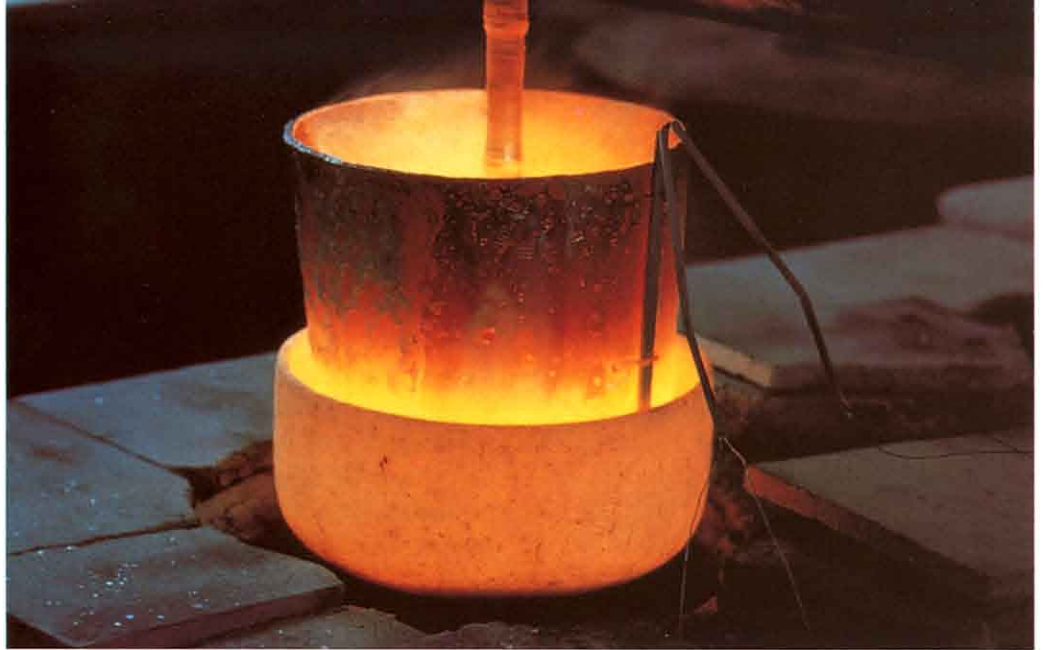
Les verres optiques de très haute qualité sont fondus selon des formules spécifiques propres à Leica.
