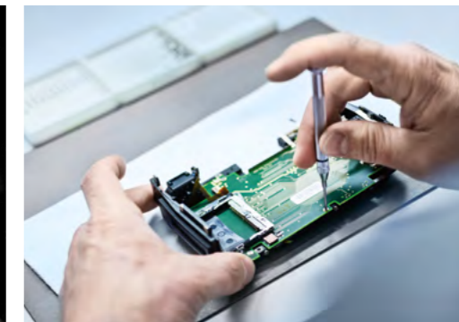
Montage de l'écran de contrôle à l'arrière du boîtier du Leica S2.
